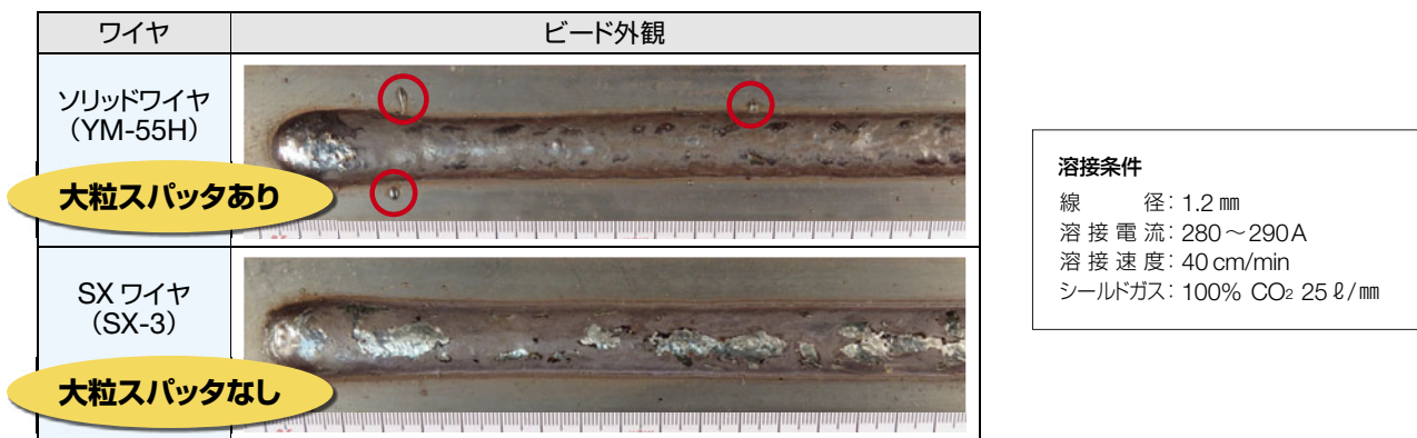
写真3 ソリッドワイヤとSXワイヤ ビード外観及び鋼板へのスパッタ付着状況の比較例
