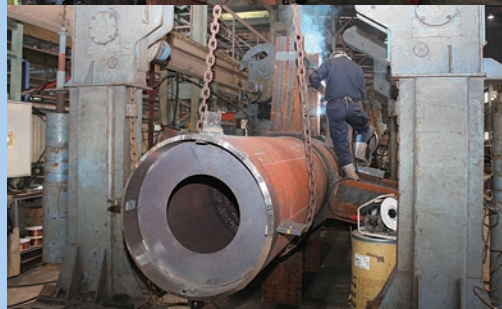
さまざまな形状や長さの柱梁を溶接
