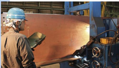
2電極CO<sub>2</sub>片面溶接
