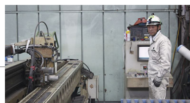
クランプシーマー溶接装置を駆使し胴板を突合せ溶接
