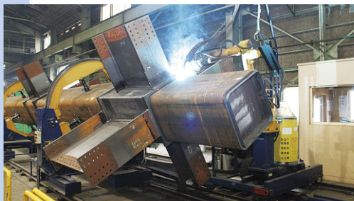
柱大組立溶接ロボット
