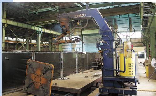
他社製天吊式溶接ロボットにYM-55C(R)が使われている
