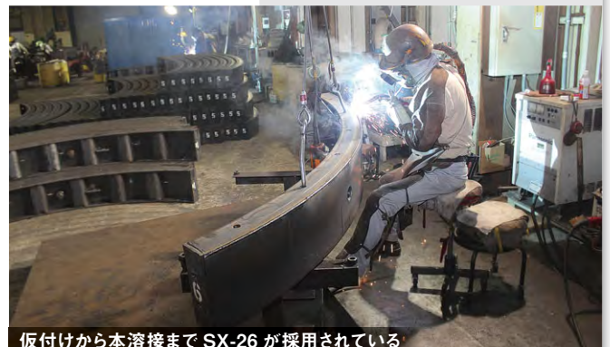
仮付けから本溶接までSX-26が採用されている
