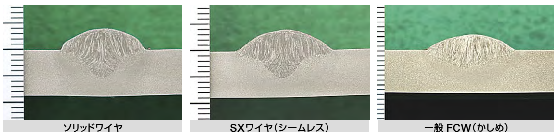
図2 | 溶込み形状の比較(下向きビードオンプレート溶接 電流300A)
