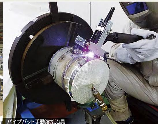
パイプバット手動溶接治具
