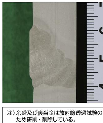
写真 1 溶接部断面マクロ
