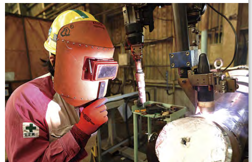
溶接ロボットによる溶接状況を確認する作業者
