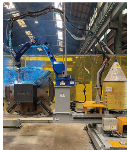
コマツ製建築鉄骨溶接ロボットRAL20シリーズを使用したSXワイヤの溶接風景
