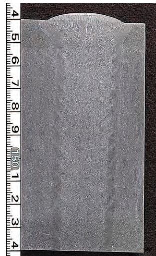
写真 2 マクロ断面写真の一例 (板厚 100mm)
