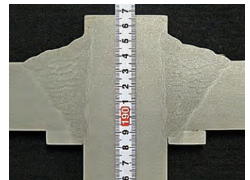
写真2 ロボット溶接による積層比較(左：SXワイヤ、右：ソリッドワイヤ)
