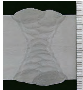
写真8 SF-80A 板厚 38mm 立向上進溶接による断面マクロ
