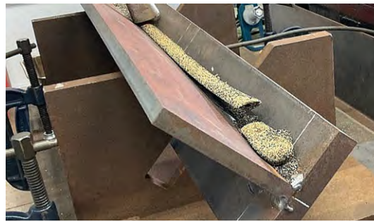
写真4 スラグ剥離状況
