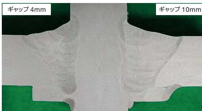
写真9 円形鋼管×SX-26の溶込み形状
