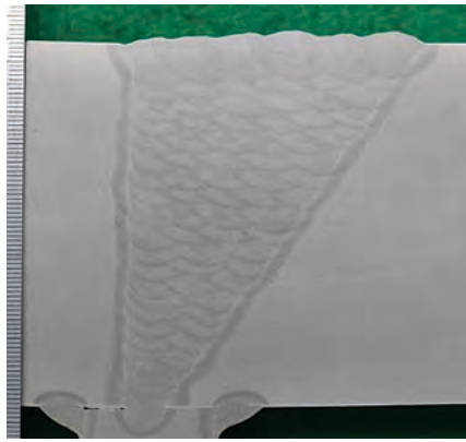
写真1 SX-80CF 下向溶接 (板厚 80mm)の ビード外観およびマクロ断面形状の一例
