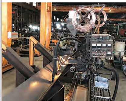
サブマージアーク溶接
