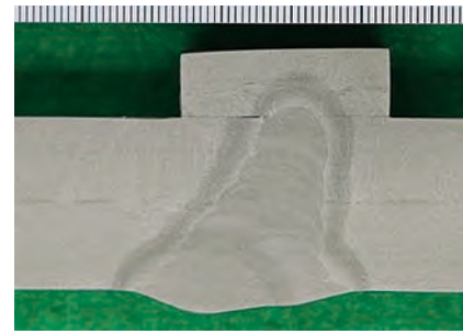
写真2 SF-80CF 立向上進溶接 (板厚 25mm)の ビード外観およびマクロ断面形状の一例
