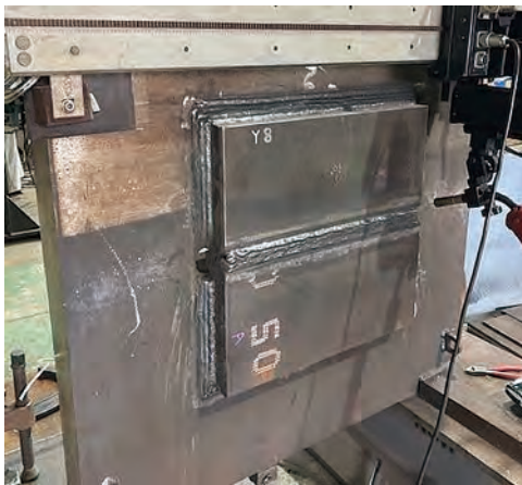
写真5 窓形拘束溶接割れ試験の状況 (窓枠材: BT-HT385 板厚 100mm)
