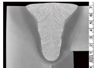
写真2 マクロ断面(板厚 60 mm)
