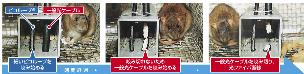
写真2 ねずみかじり試験
