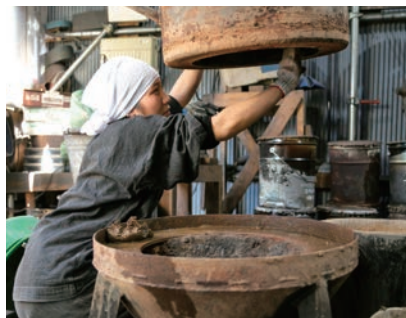
炉壁にも粘土を塗り付ける
