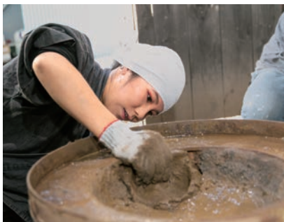
炉底に粘土を塗る
