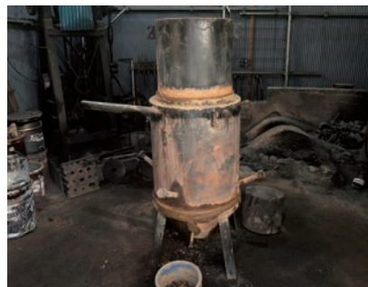
炉を組み立て1週間以上かけて 粘土を乾かす
