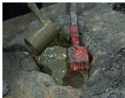
酸化しないように藁灰と粘土汁をかける
