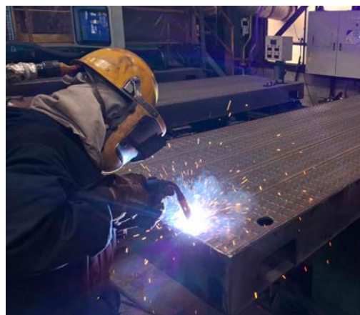
仕上げ溶接状況
