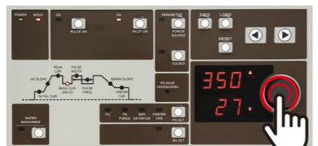
可以预先设置20种主要钢材的焊接参数。
