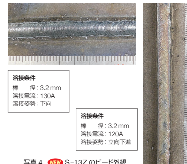
写真4 NEW S-13Zのビード外観
