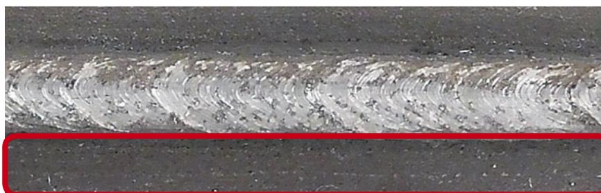
写真 2 A-10の鋼板へのスパッタ付着状況
