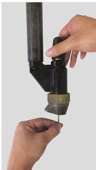
写真1 電極棒交換風景
