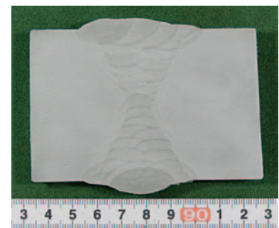
写真 1 SF-36E 立向継手の断面マクロ
