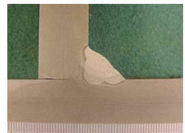
写真2 3パスすみ肉溶接の断面マクロ写真
