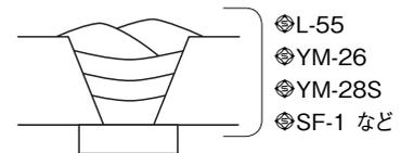
全層 軟鋼・490MPa 級高張力鋼用溶接材料での溶接
