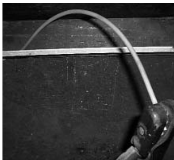
写真1 溶接棒を曲げての溶接(3.2mm)
