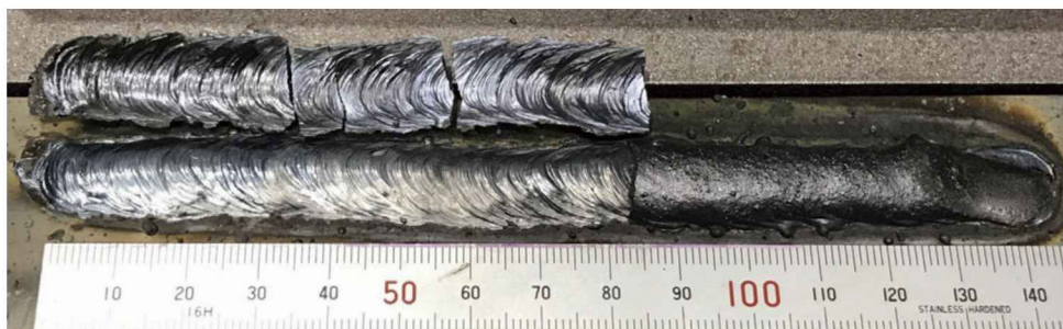
写真 1 下向溶接後の外観
