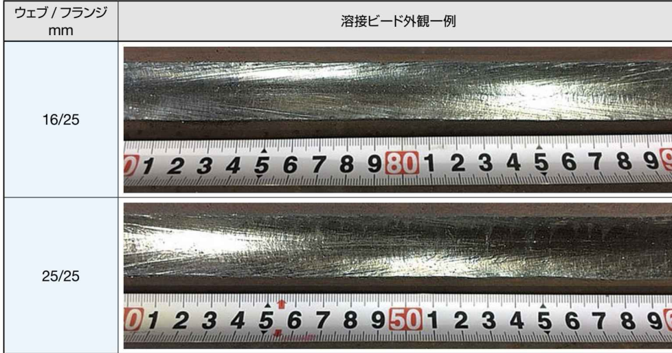
写真 1 Y-D×NF-800R 下向きすみ肉溶接金属の溶接ビード外観一例
