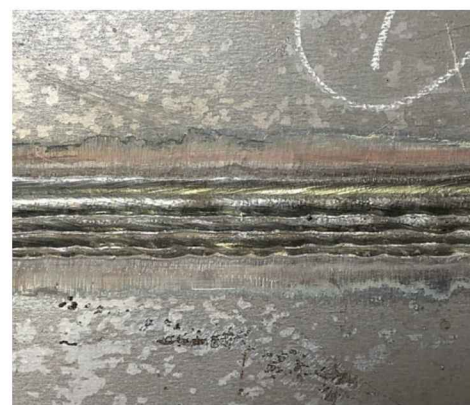
写真 2 溶接ビード外観
