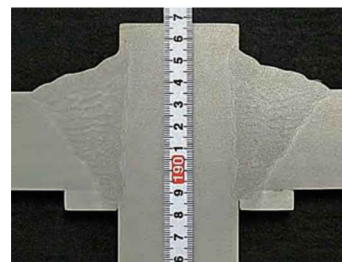
写真2 ロボット溶接による積層比較(左：SXワイヤ、右：ソリッドワイヤ)
