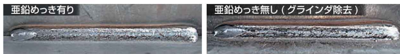
写真3 亜鉛めっき鋼板でのSX-26溶接ビード外観 (母材:SM490A めっき厚:20μm 溶接条件:250A-28V)
