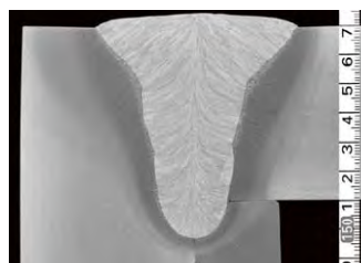
写真2 マクロ断面(板厚 60 mm)
