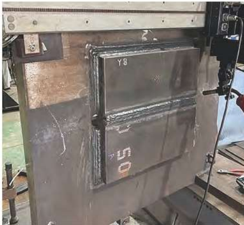
写真5 窓形拘束溶接割れ試験の状況 (窓枠材: BT-HT385 板厚 100mm)
