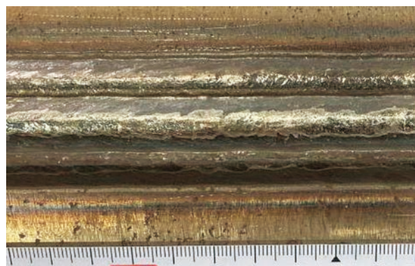
写真 3 SX-80A.CF 溶接継手の溶接ビード外観
