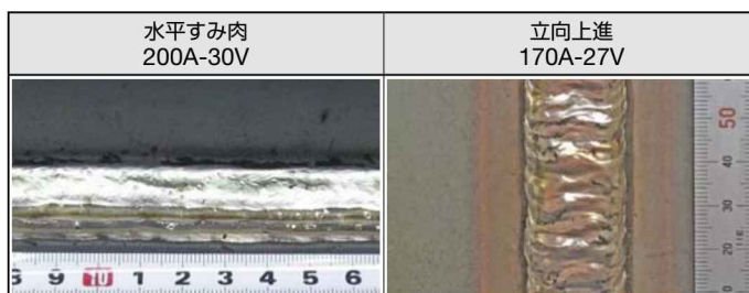
写真1 FC-9NIの溶接ビード外観
