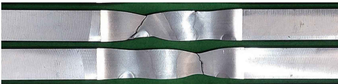
写真 2 継手引張試験片の破断写真 (SX-55HC)
