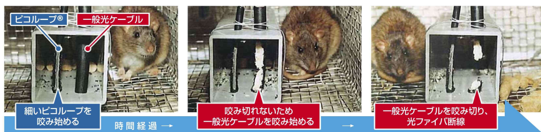
写真2 ねずみかじり試験
