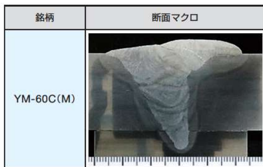
写真1 YM-60C(M)の断面マクロ一例
