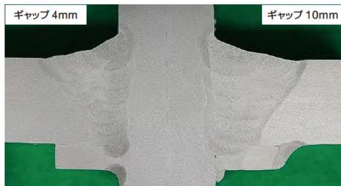
写真9 円形鋼管×SX-26の溶込み形状
