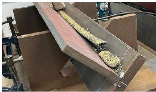
写真4 スラグ剥離状況
